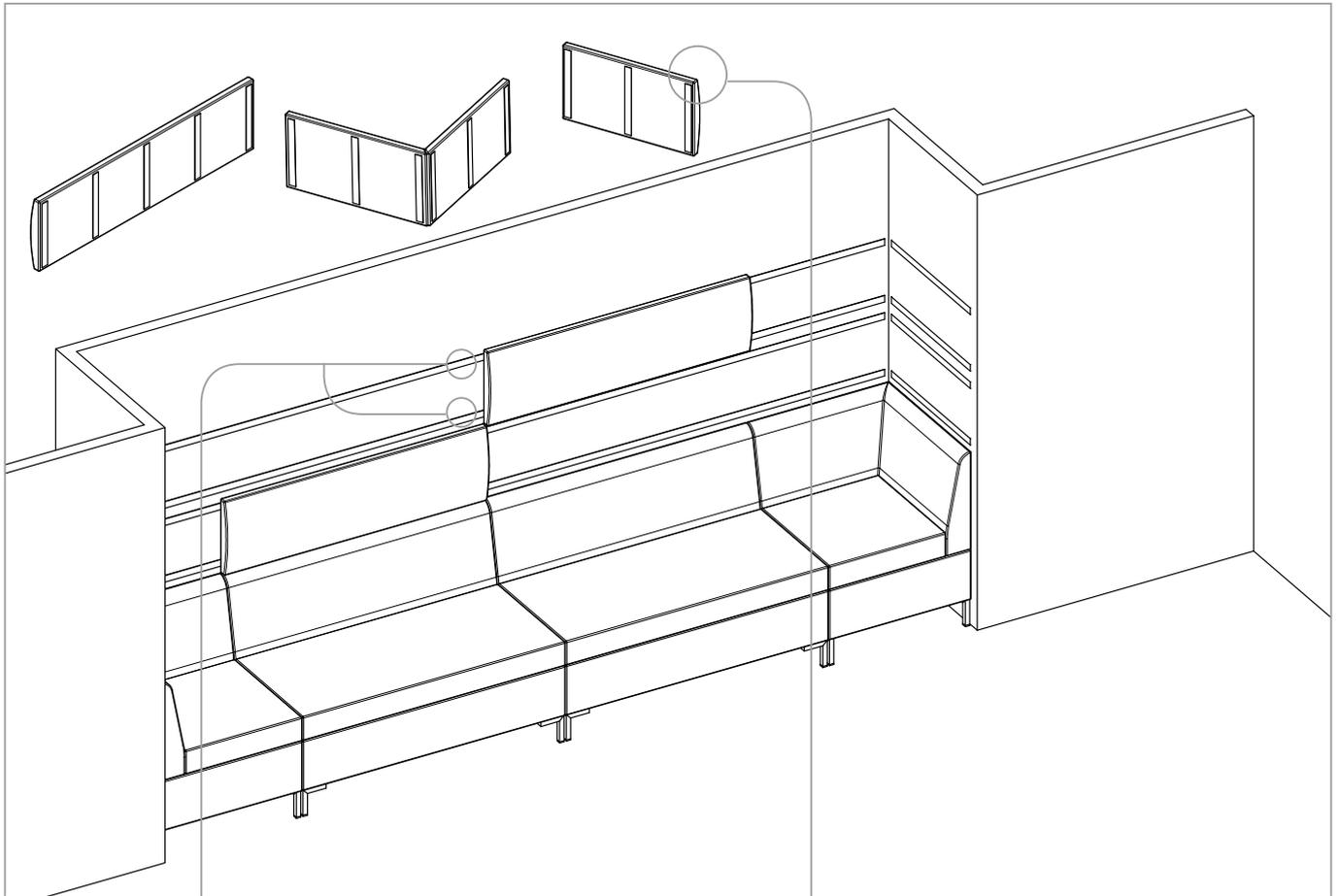
Les bandes de Velcro adhésif doivent être fixes horizontalement sur le mur.
